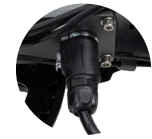
Akumulator podłączony do sterownika
