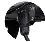
An den Controller angeschlossener Akku
