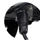
Batteria collegata al controller
